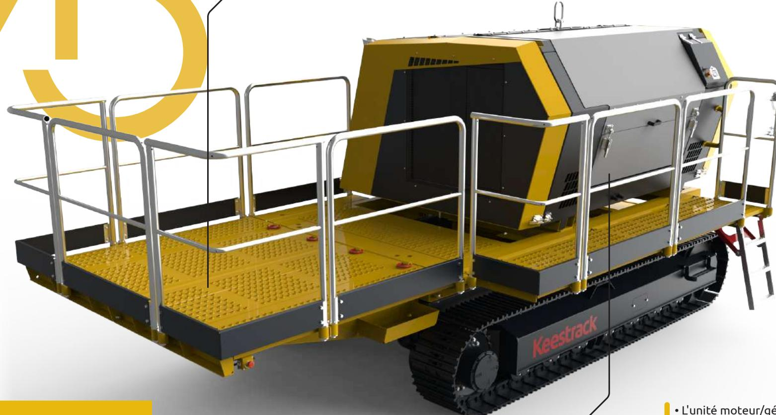
L'unité moteur/générateur sur chenilles peut alimenter directement en électricité les concasseurs, cribles et tapis autonomes électriques connectés, dans le cas où il n'y a pas de connexion au réseau disponible. De cette manière, les avantages économiques du train de production complet augmentent grâce à l'utilisation d'un seul moteur pour plusieurs machines.
